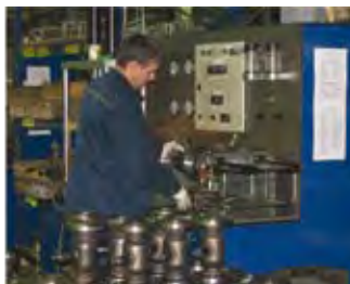
Тестирование шаровых кранов
