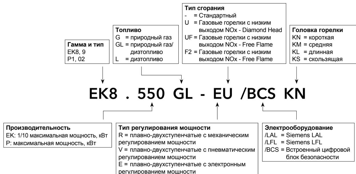
Моноблочные горелки HO-Tron и GHO-Tron
